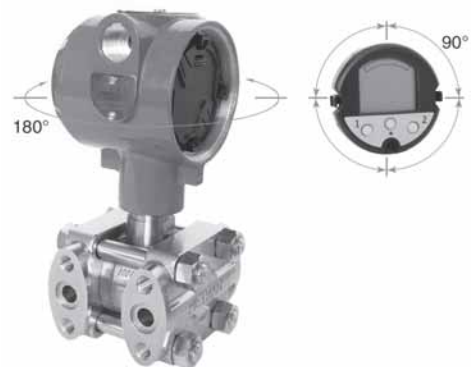
Рис.3. Возможность поворота ЖКИ и электронного преобразователя датчика Метран-150 моделей 150CD, 150CG, 150TG, 150TA.
