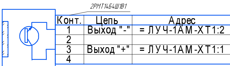
Рис.9. Выходные электрические цепи фотодатчика ФД-03(ФД-03Т).
