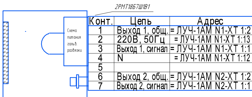
Рис.11. Выходные электрические цепи фотодатчика ФД-05ГМ.
